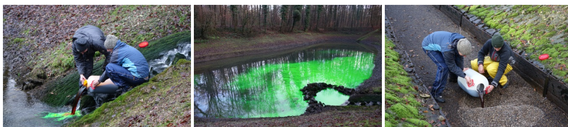
Abb. 3.8: Eingabe der Markierstoffe am 11.01.2016; links: Eingabe Uranin in Weiher 5, Mitte: Ausbreitung Uranin in Weiher 5, rechts: Eingabe Naphtionat in Kanal C.
