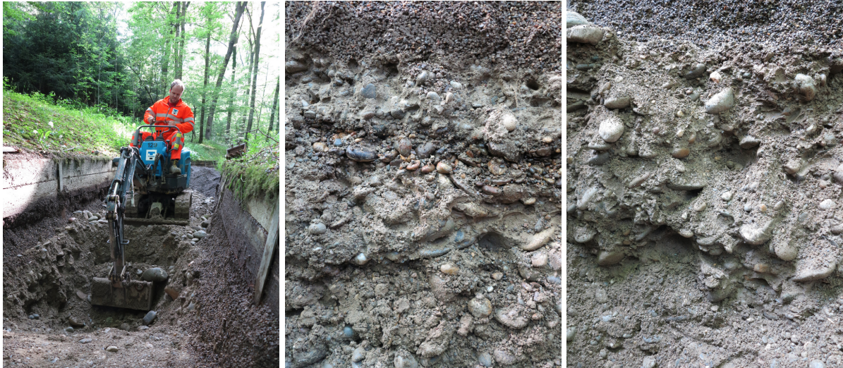
Abb. 3.3: Entnahme der Bodenproben im Graben C (links) und Profilsicht (Mitte und rechts). Im oberen Teil der Profile ist die künstliche Kiesschicht zu sehen, darunter ist der gewachsene Boden.
